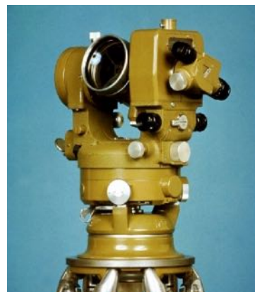
Wilds Theodolit Kern DMK3 (1939). Genauigkeit 0.1 sec.
