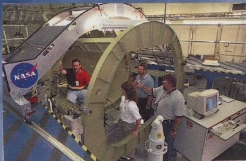
2000: Mit Laserscanner aus Unterentfelden/AG kontrolliert: die CRV X-38 Rettungsfähre. ((RE41))
